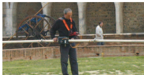
Prospection électromagnétique (appareil Géonics Type Em 31d)
