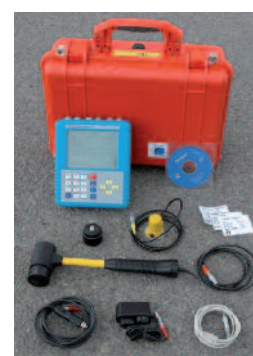
Testeur d'intégrité de pieu
