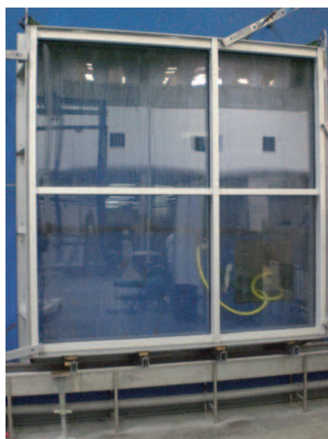
Essai Air Eau Vent
