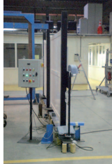
Essai d'endurance sur portail
