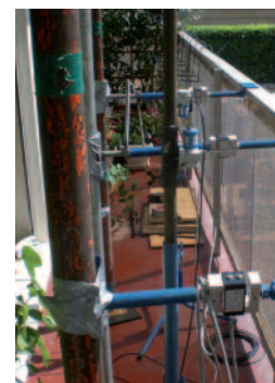
Essai statique sur garde-corps
