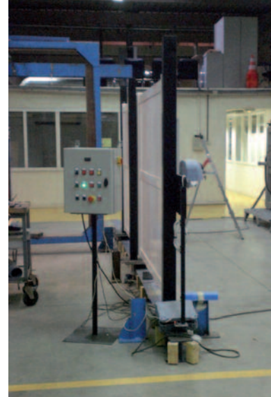
Essai d'endurance sur portail
