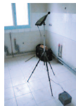
Mesure acoustique in situ au sonomètre
